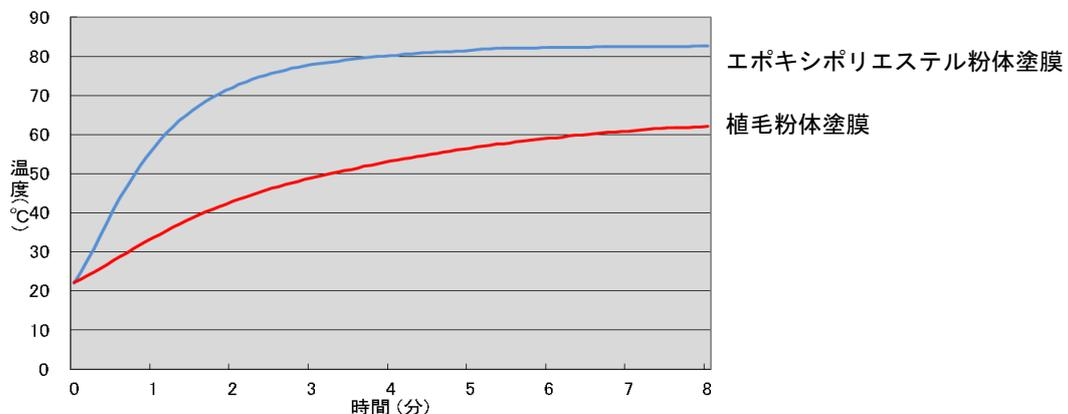
100°Cのホットプレートで塗板(鋼板)を加温した時の表面温度変化
